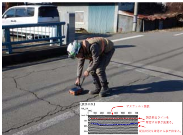
電磁波レーダ法による床版調査
