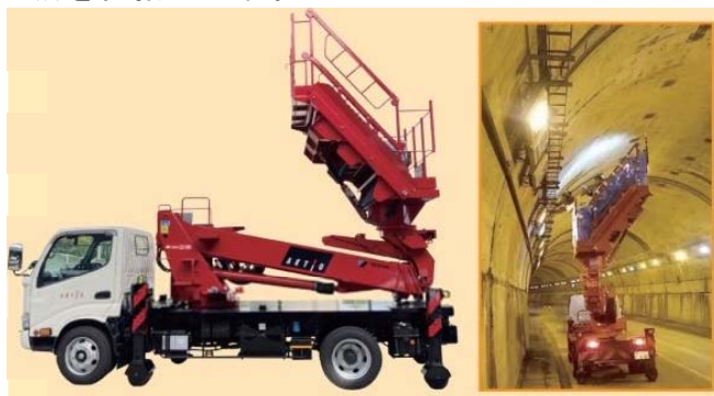
トンネル点検用作業車の活用
